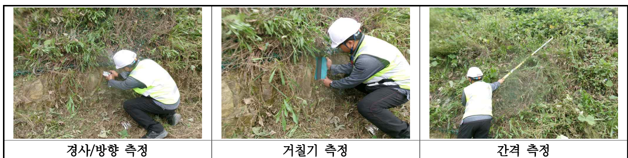
【사진 27.3.2】 불연속면 측정 현황
